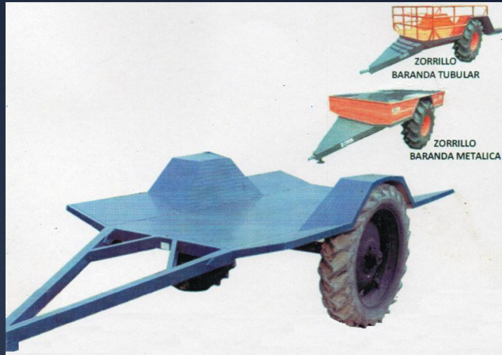
VAGON FABRICADO EN LAMINA CORRUGADA, CHASIS REFORZADO, EJE RIGIDO Y TIRO FIJO
