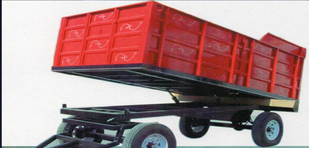
CHASIS REFORZADO, DIRRECCION QUINTA RUEDA, EJE RIGIDO Y TIRO FIJO, BOTELLA HIDRAULICA
