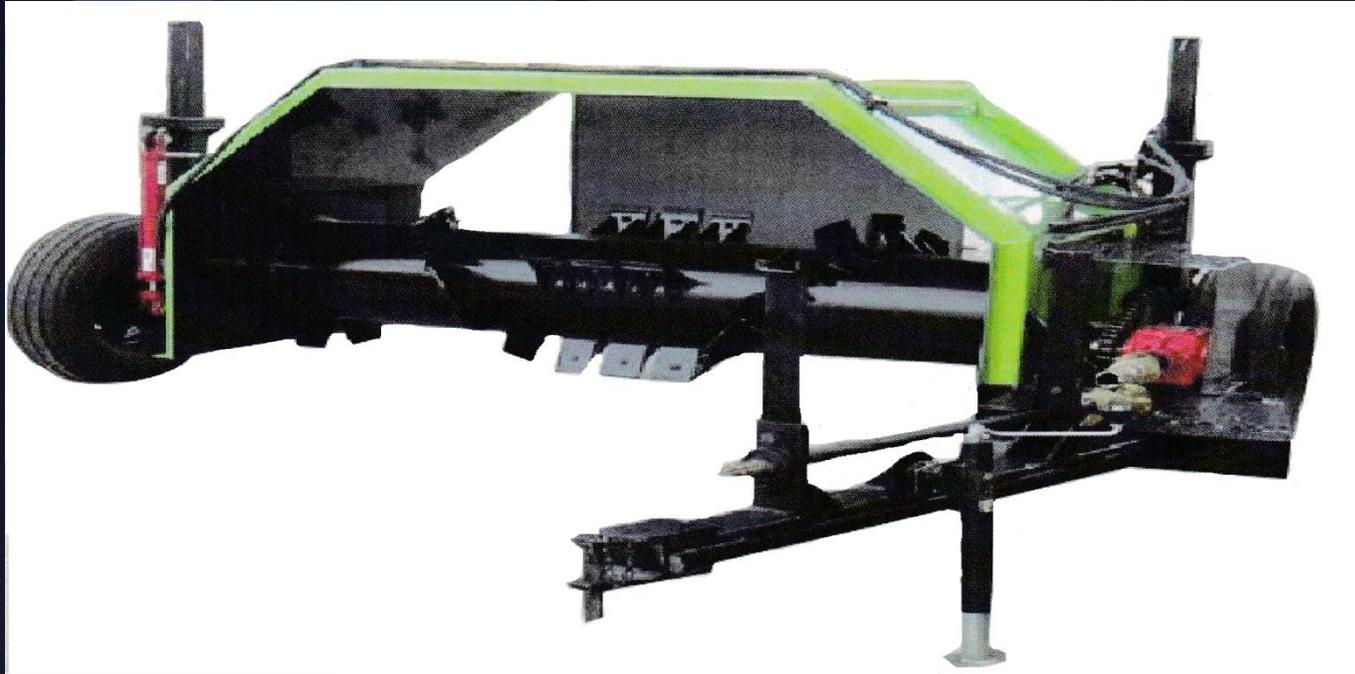
DE TIRO FIJO, EJE CENTRAL EN TUBERIA, CUCHILLA ANCLADA A TUBO CENTRAL, ENGANCHE AL TIRO DEL TRACTOR
