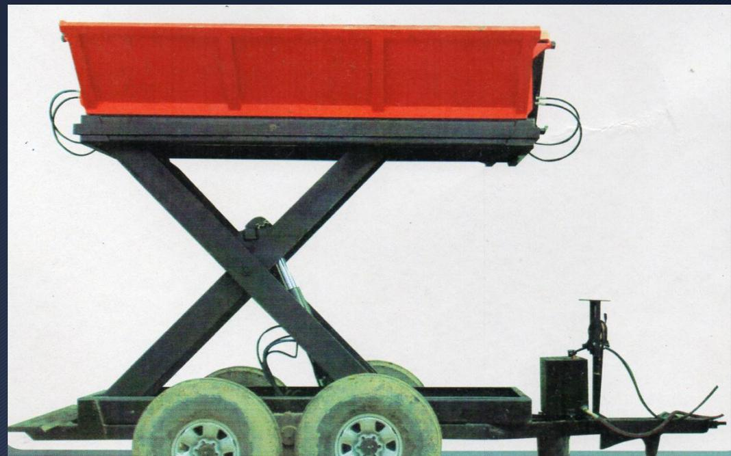
ZORRILLO DE TIJERAS VOLTEO LATERAL EJE RIGIDO LLANTA CON SISTEMA TANDEM
