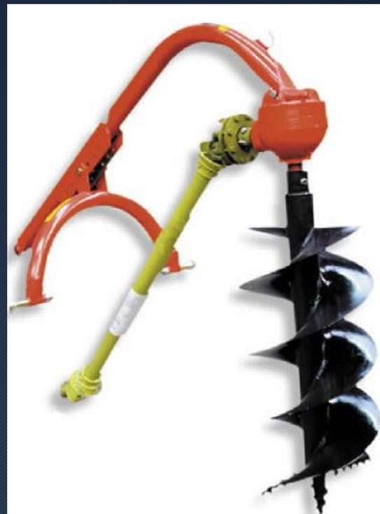
TRANSMISION AGROTEC, BROCA EN ACERO DE 1/4, CUCHILLAS CAMBIABLES, SUPLEMENTOS INTERCAMBIABLES DE ACUERDO AL TRABAJO
