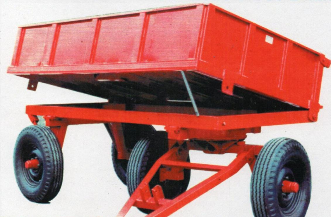
CHASIS REFORZADO, DIRRECCION QUINTA RUEDA, EJE RIGIDO Y TIRO FIJO, BOTELLA HIDRAULICA
