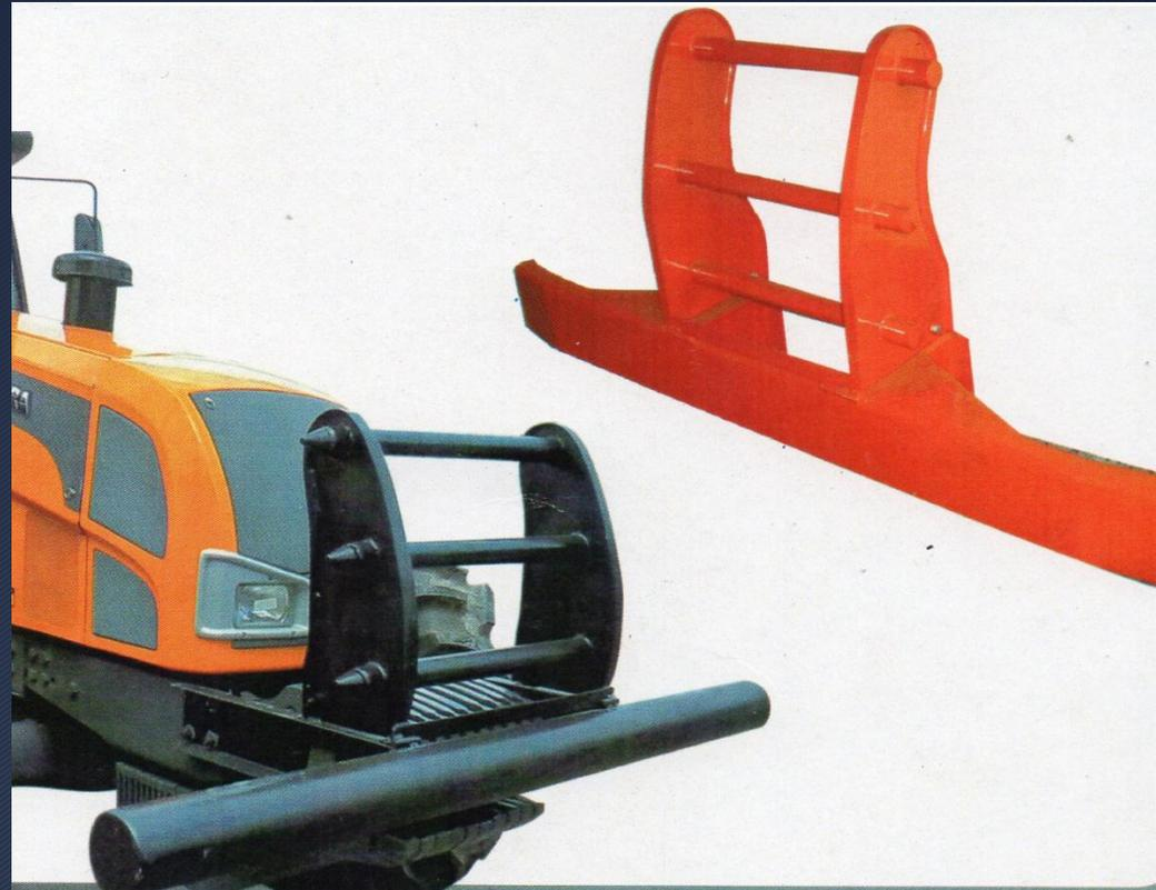
FABRICADO EN LAMINA LISA, FRONTAL EN TUBO O CANAL U6
