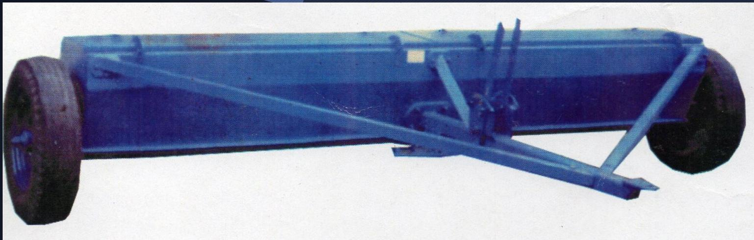
CAJON CONSTRUIDO EN LAMINA LISA A-1/8 Y REFUERZOS EN A-1/4 EJE CENTRAL EN ACERO DE 1 1/2°
