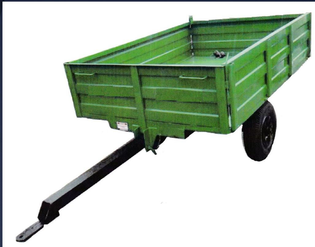
CHASIS REFORZADO, EJE RIGIDO Y TIRO FIJO, PLANCHON EL LAMINA ALFAJOR
